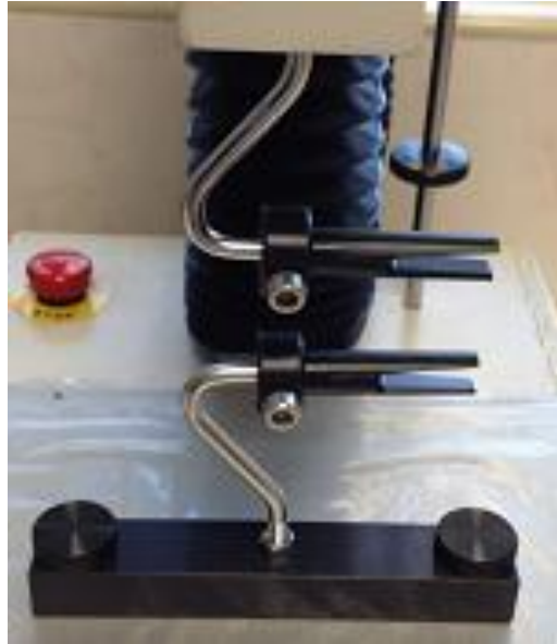
Figura 8.- Aditamento A/SPR para medir la tensión en las pastas.
