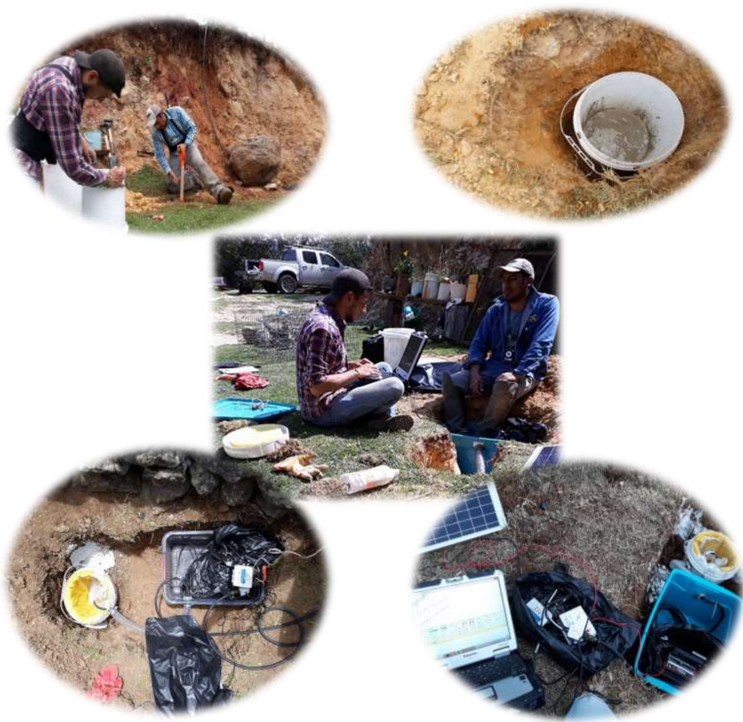
Figura 6. Registros fotográficos de la preparación e instalación de cada una de las 16 estaciones sísmicas de la zona de estudio.
