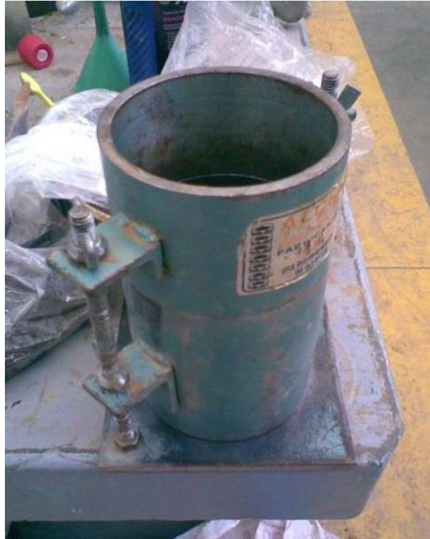
Figura 36: Molde para compactación tipo Proctor.
