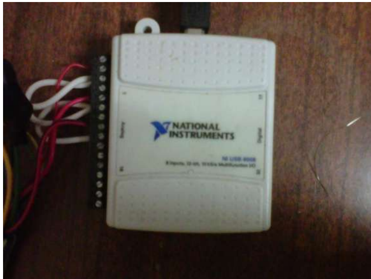
Figura 66: Tarjeta que captura los datos de los sensores en la máquina de corte directo USB NI.
