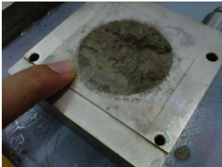
Figura 51: Muestra correspondiente a C3 después de la prueba de corte, placa superior.
