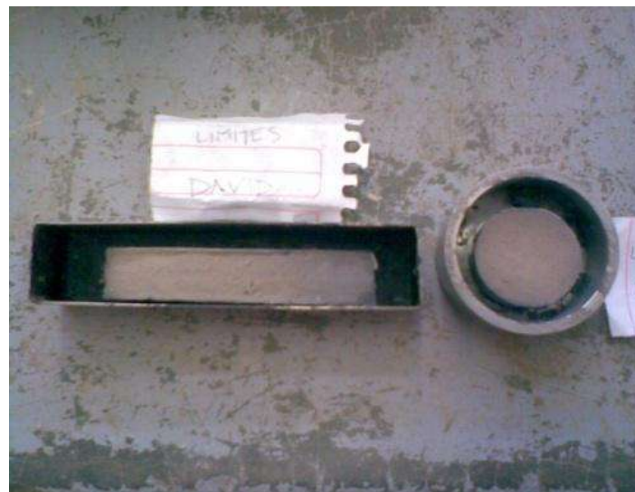
Figura 34: Muestras después del secado para determinar su contracción lineal y volumétrica.
