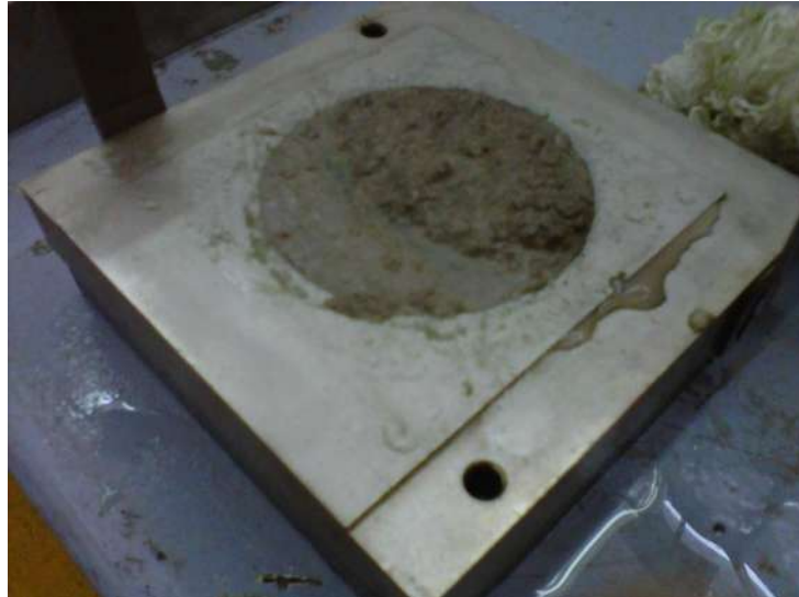
Figura 62: Muestra de arcilla después de la prueba a corte con método anterior.
