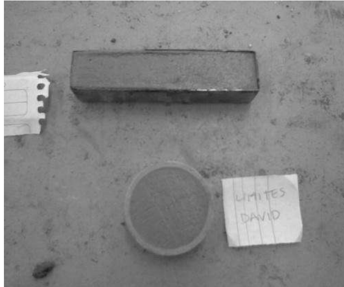
Figura 33: Muestras para determinar la contracción lineal y volumétrica de la arcilla.
