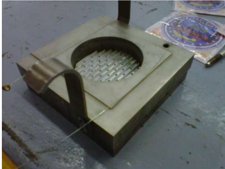
Figura 48: Implementación de las cuerdas en los extremos de la sección circular.
