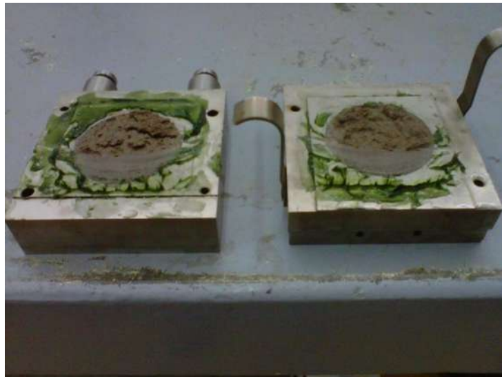
Figura 59: Implementación de la grasa en las paredes de las placas para la prueba G.
