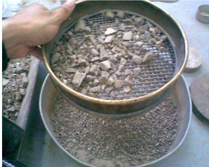
Figura 38: Cribado del material por la malla no. 4.
