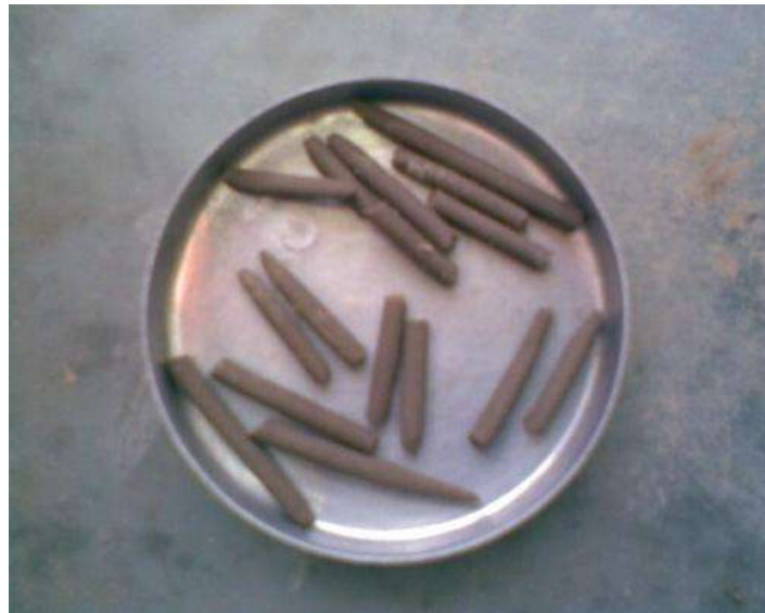
Figura 32: Rollitos de arcilla para determinar el límite plástico.
