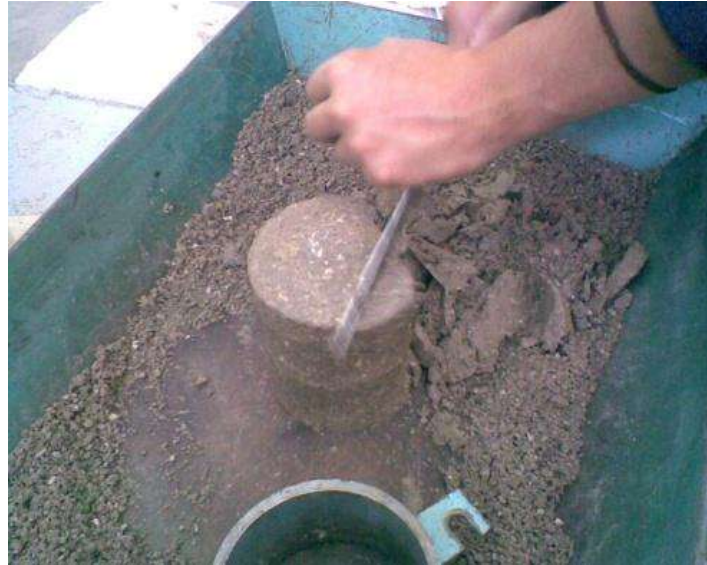
Figura 44: Espécimen de compactación tipo Proctor y la extracción de muestras representativas.
