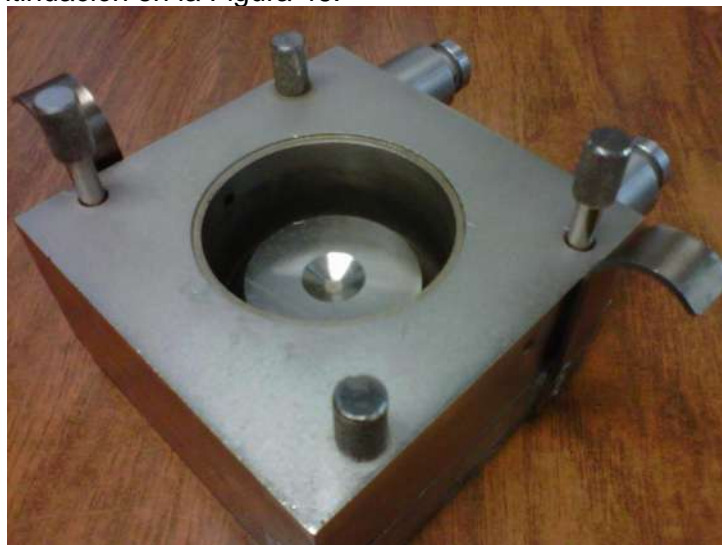
Figura 46: Placas de corte directo, sección circular.
