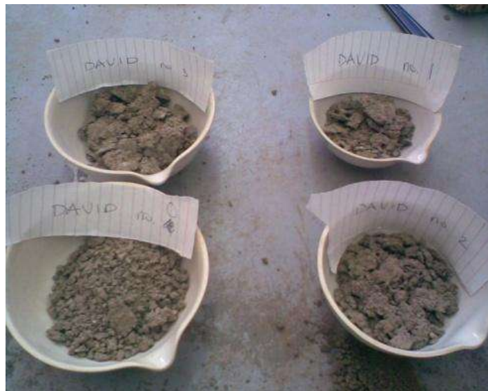
Figura 45: Material representativo de cada ciclo (Proctor), para determinar su humedad.
