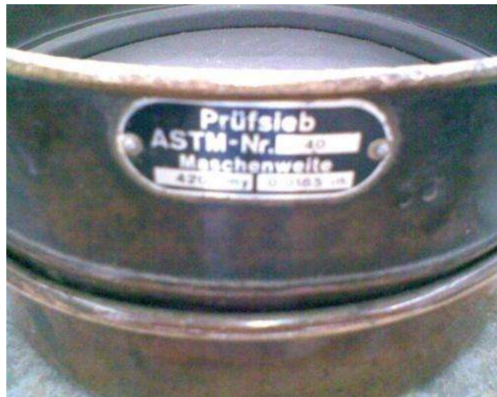
Figura 28: Cribado en la malla número 40.
