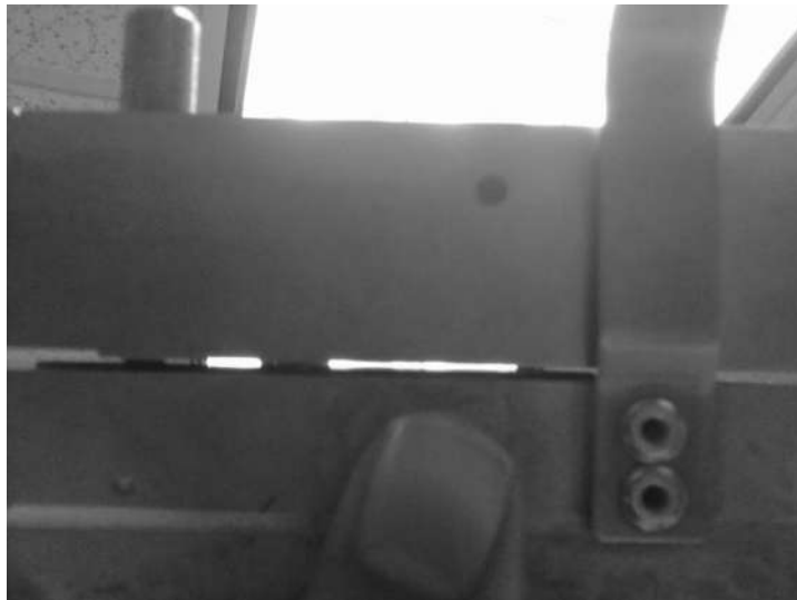
Figura 61: ejemplificación del momento en el que se eleva la placa superior al girar los tornillos auxiliares.
