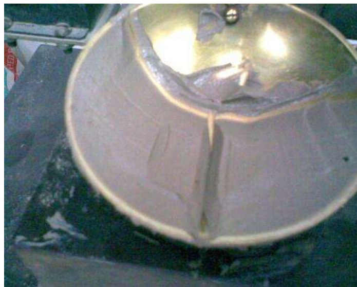
Figura 30: Cierre de la brecha de arcilla en la copa de Casagrande.
