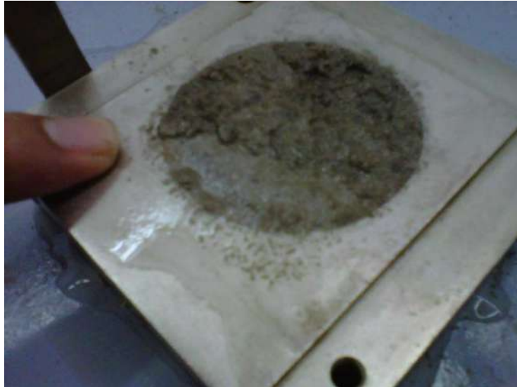
Figura 52: Placa inferior de la muestra C3, muestra como se corto la muestra de arcilla.
