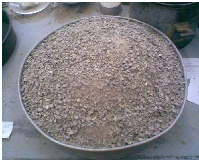
Figura 40: Material secado en horno para eliminar humedad.
