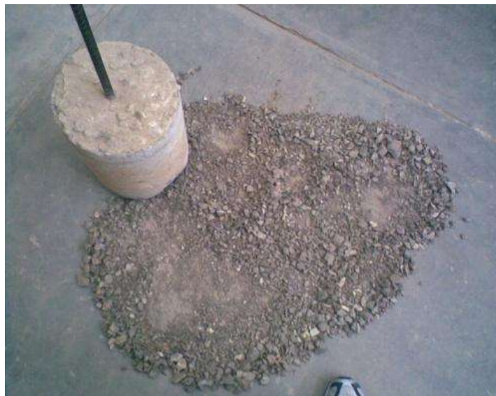
Figura 37: Triturado de material arcilloso que es demasiado grande.
