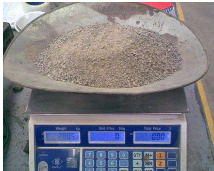
Figura 39: Pesaje de 2.5kg de material arcilloso.
