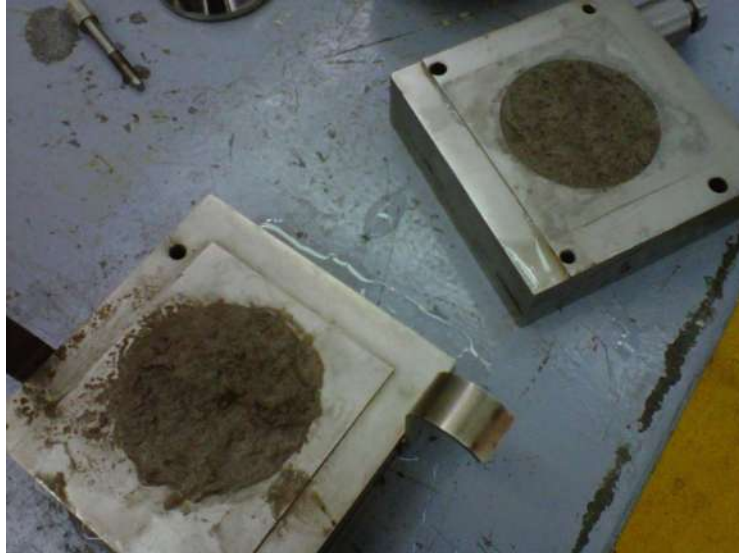
Figura 54: Muestra con inducción de la falla, con una cuerda de guitarra (SOL).
