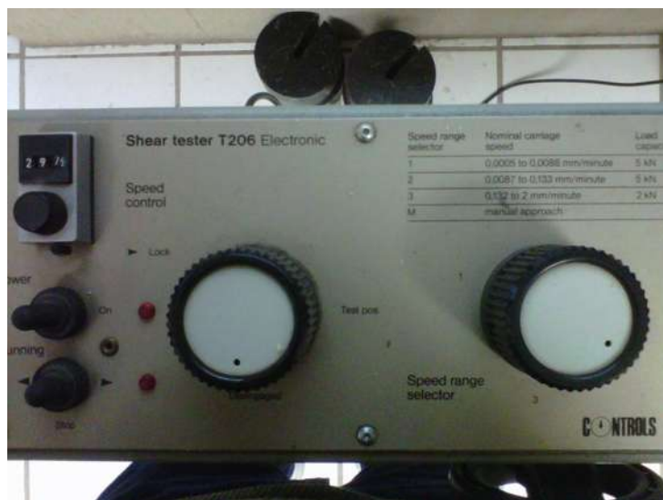
Figura 70: Tablero de controles de la máquina de corte directo.
