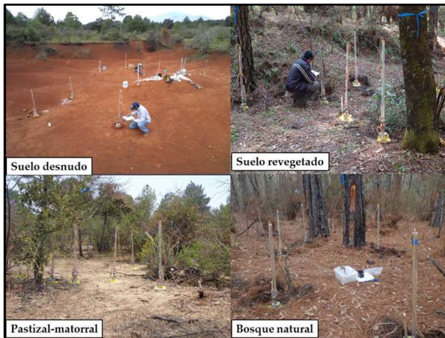
Figura 4. Uso de los infiltrómetros de disco-tensión automatizados para los ensayos de infiltración en campo en cada sitio.
