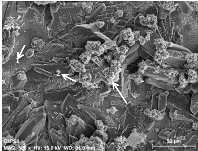
Figura 4.11 Micrografía de MEB de la muestra CaPS4 a 500X donde se indican las 3 zonas de análisis por EDS.
