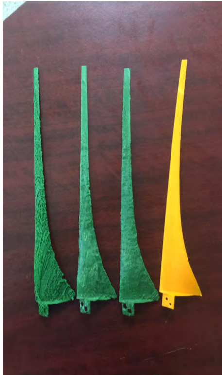
(a) Pruebas de impresión 3D en material PLA de las aspas del rotor de 50 W. Se realizaron distintas pruebas hasta alcanzar la forma y el acabado deseado.
