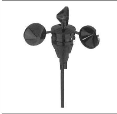
Figura 2.5: Anemómetro de copas para medición de la velocidad del viento. [Fuente: Libro wind energy explained.]
