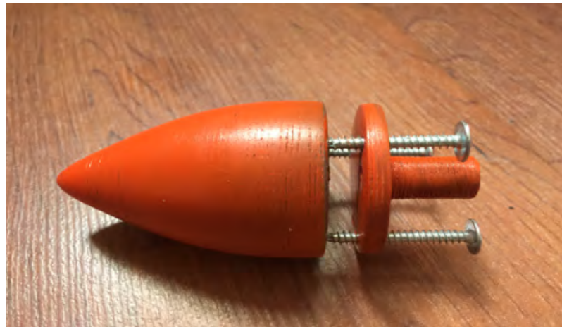
(c) Hub y portahub del rotor de 50 W, impresos en material PLA mediante tecnología 3D
