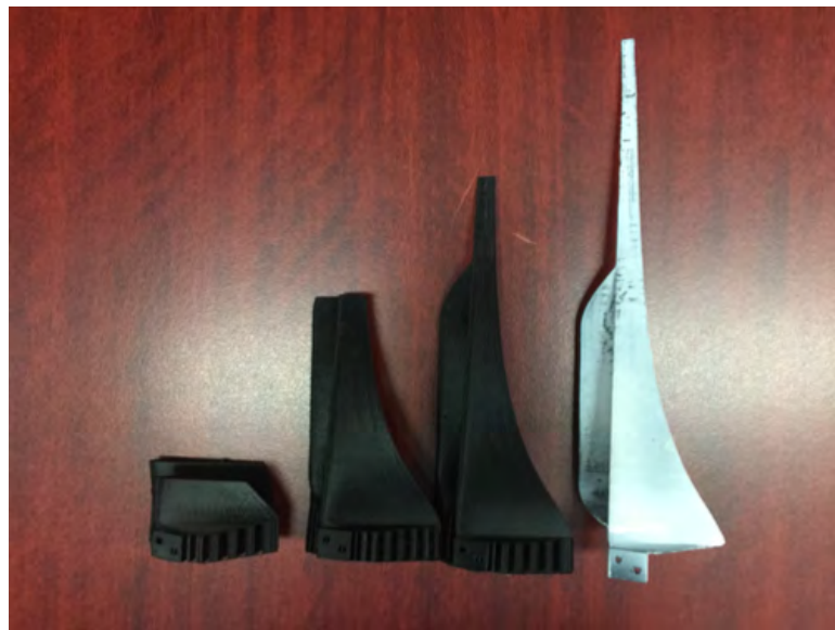
Figura 6.9: Pruebas de impresión realizadas con distintas configuraciones de temperatura de la boquilla y velocidad de deposición de material. [Fuente: Información y elaboración propia.]
