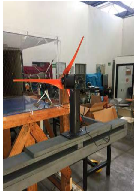
(b) Rotor de 50 W montado sobre el cabezal del torquímetro para medir el torque de arranque que se genera durante la incidencia del aire en los álabes.
