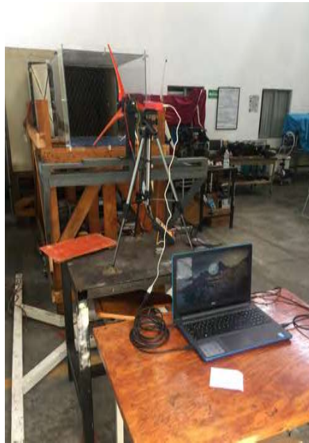
(a) Instrumentación usada para medición de los parámetros de arranque. El tacómetro montado sobre el trípode, el anemómetro sobre la sección transversal del túnel y el voltímetro conectado a la parte trasera del rotor.
