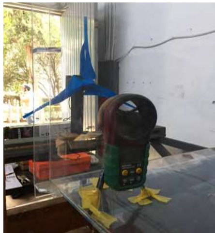
(c) Validación de la velocidad de salida del túnel de viento mediante un anemómetro.
