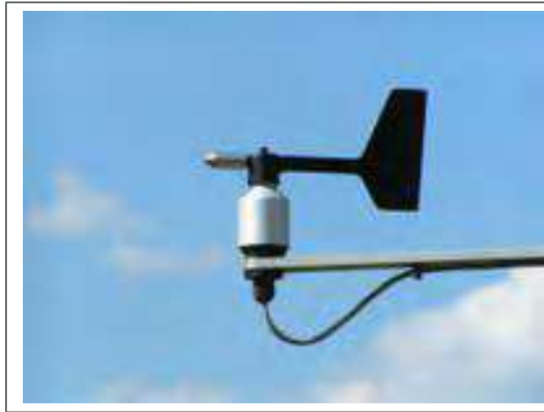
Figura 2.7: Veleta, instrumento que nos ayuda a determinar la dirección en la cual se mueve el viento. [Fuente: Libro wind energy explained.]
