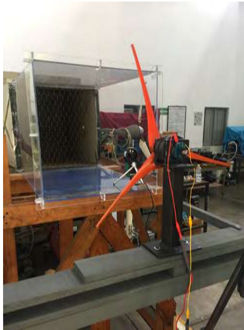
Figura 5.19: Rotor de 50 W montado en el túnel de viento para ser ensayado y poder caracterizar los parámetros involucrados en la fase de arranque. [Fuente: Información y elaboración propia.]
