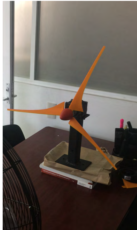
(b) Rotor de 50 W de material PLA, impreso mediante tecnología 3D
