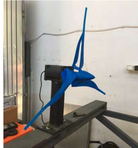
(b) Medición del torque aerodinámico de arranque mediante un torquímetro.
