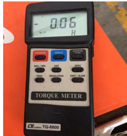
(d) Torquímetro utilizado para medir el torque generado por el rotor de aspas de doble raíz durante la incidencia del viento en su superficie.
