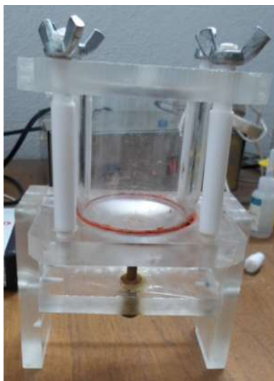
Figura 2.1: Recipiente para ataque electroquímico.
