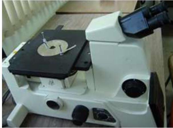
Figura 4.1: Microscopio óptico de banco NiKON EPIPHOT 300.
