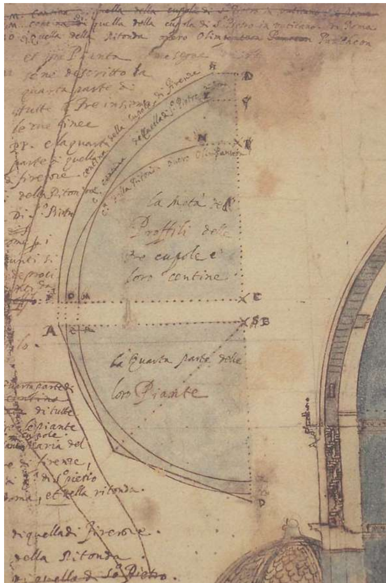
39.- Trazo y dimensionamiento de la b6veda de Florencia..
