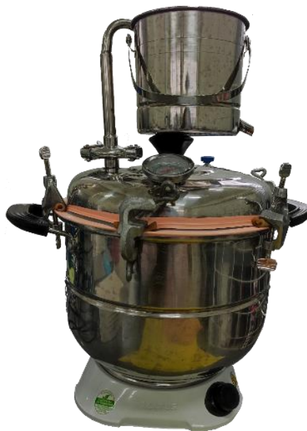
Figura 7.3.- Equipos para hidrodestilación del aceite esencial de T. lucida a.- Esquema del hidrodestilador a escala laboratorio y b.- Alambique
