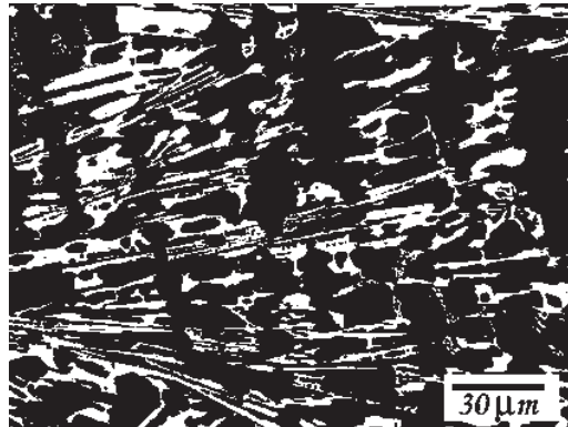
Figura 2.1 Fotomicrografía de una Muestra del Hierro Blanco Experimental en Condiciones de Colada Sometida a Ataque Profundo para Generar Alto Contraste entre la Matriz (Oscura) y el Carburo Eutéctico (Blanco). Microscopio Óptico 250x.
