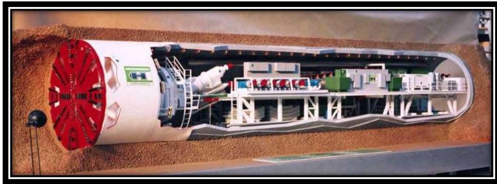
Figura 12.- Túneladora Tipo Escudo.
