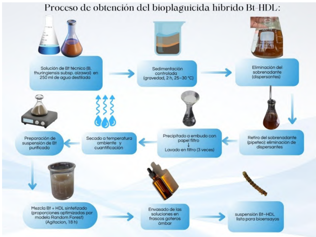
Figura 14. Diagrama de flujo del proceso de obtención del bioplaguicida híbrido Bt-HDL.
