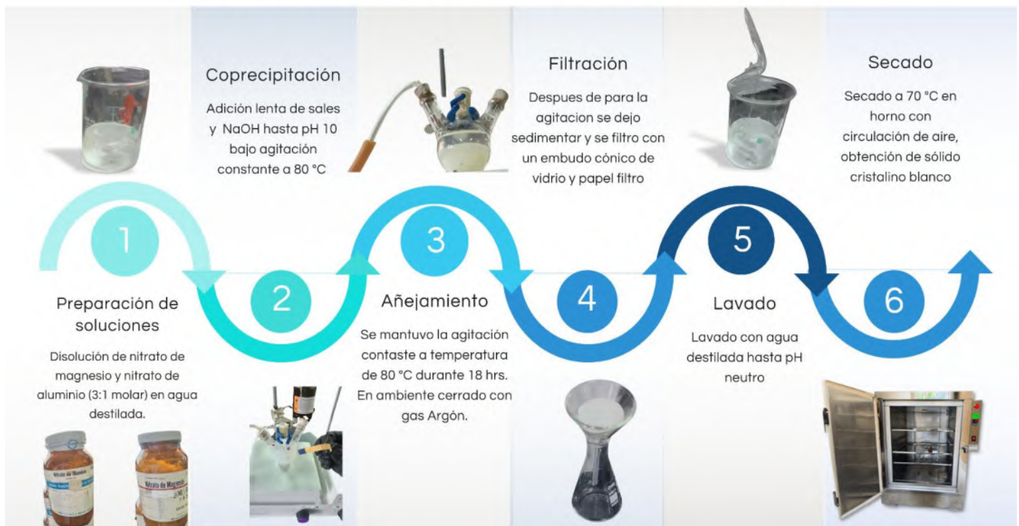
Figura 13. Proceso de síntesis de hidróxidos dobles laminares (HDL) mediante método de coprecipitación controlada.
