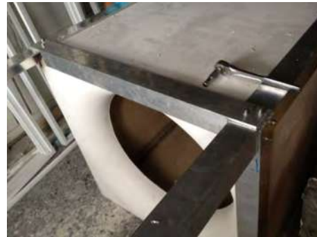
Figura 9. Estructura de la torre de enfriamiento.
