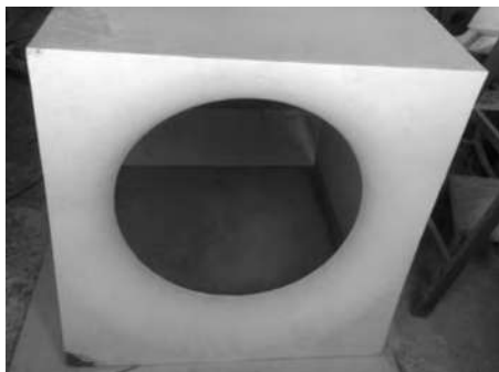
Figura 7. Mamparas y difusor de aire fabricados de fibra de vidrio.
