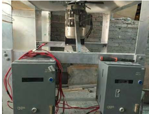
Figura 119. Conexión eléctrica, motor ventilador y motor de bomba centrífuga.
