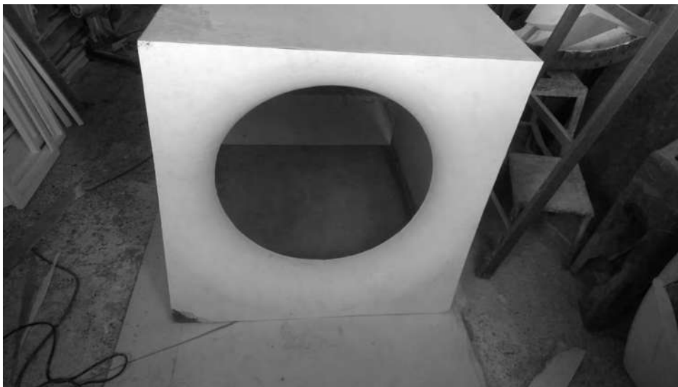
Figura 93. Terminación de la manufactura de mamparas y difusor en fibra de vidrio de la torre de enfriamiento de tiro forzado a contraflujo.
