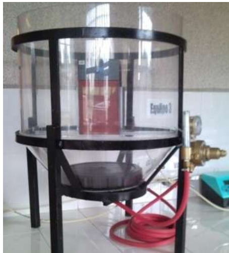
Figura 3.2. Biorreactor con membranas sumergidas
