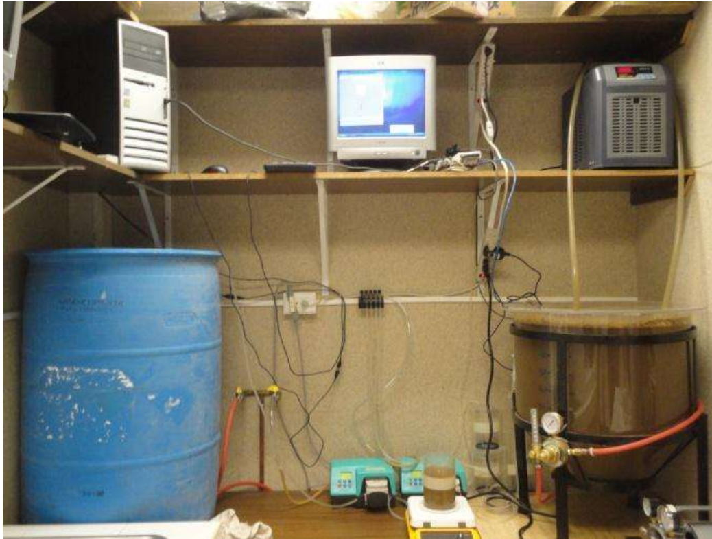
Figura 3.5. Operación del BRM
