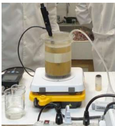
Figura 3.9. Reactor batch , haciendo lectura de parámetros
