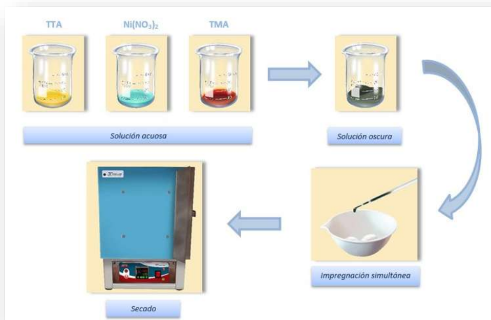
Figura 3.3 Esquema de síntesis de catalizadores mediante co-impregnación
