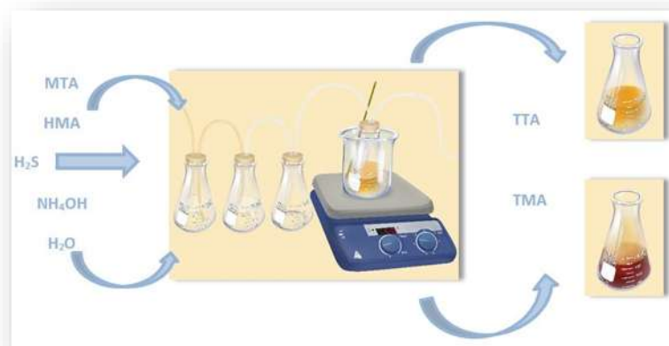
Figura 3.2 Esquema de síntesis de las tiosales de Mo y W
