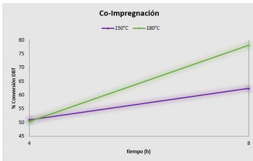
Figura 4.23 Gráfica de la interacción de los factores durante el tratamiento hidrotérmico de los catalizadores NiMoW/AlTiMg sintetizados por co-impregnación
