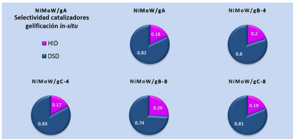
Figura 4.22 Selectividad de los catalizadores NiMoW/AlTiMg sintetizados por gelificación in-situ
