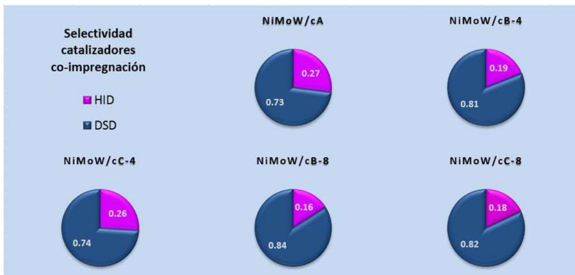
Figura 4.21 Selectividad de los catalizadores NiMoW/AlTiMg sintetizados por co-impregnación
