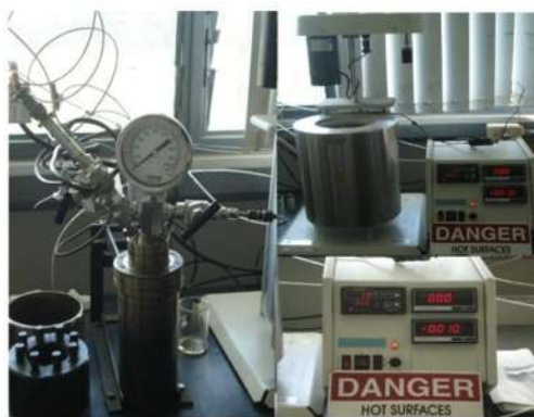
Figura 3.10 Reactor por lotes de alta presión Parr, modelo 4842
