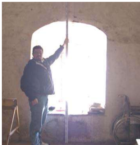
Fig. 19. Se utilizó el estadal para mediciones de alturas. Elaborado: la autora.
