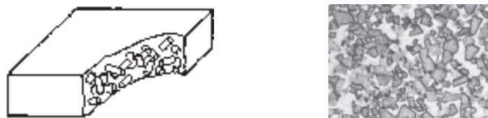
Figura 2.1. Macro y microestructura de un compósito reforzado con partículas.
