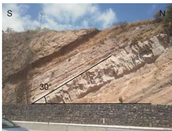
Figura 30. Fotografía tomada inmediatamente al sur del campo geotérmico de SAM donde se puede observar el basculamiento hacia el Sur de las unidades rocosas.
