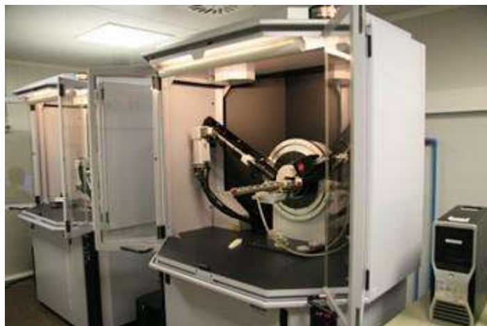
Figura 20. Difractómetro de rayos X Bruker D8 Advance (sitio de internet de la Universidad de Cataluña).
