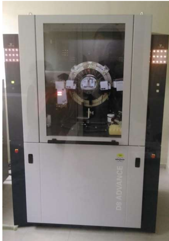
Figura 28. Difractómetro Siemens XRD 5000, en el cual se realizaron los análisis de DRX de las muestras de sínter (propiedad de la Universidad Michoacana).
