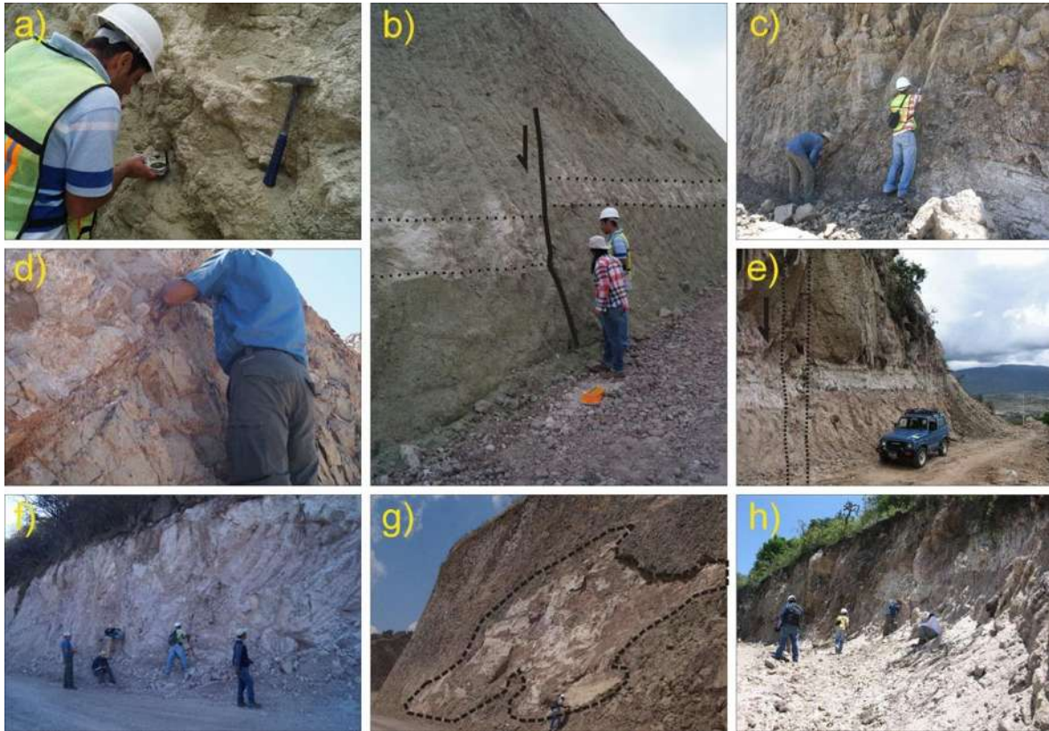
Figura 23. Trabajo de campo enfocado a la recopilación de datos de geología estructural; a) medición datos estructurales en la zona sur del Lago de Cuitzeo; b) falla normal de dirección NE; c) mediciones de datos estructurales cerca de la comunidad de Buena Vista municipio de Chucándiro; d) mediciones estructurales; e) pequeña zona de falla en la comunidad de Buena vista; f) compañeros de la maestría y proyecto 17 del Cemie levantando los datos de indicadores cinemáticos; g) importante plano de falla (entre línea punteada) encontrado cerca de la comunidad de la Yerbabuena municipio de Copándaro (falla de dirección ENE de tipo lateral izquierda); h) compañeros del proyecto 17 del Cemie apoyando con la recolección de datos de campo.
