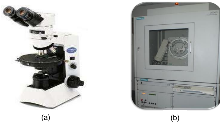
Figura 13. Imagen del microscopio óptico de luz polarizada utilizado para la cuantificación del V V (a). Equipo de Difracción de Rayos SIEMENS-500 (b).
