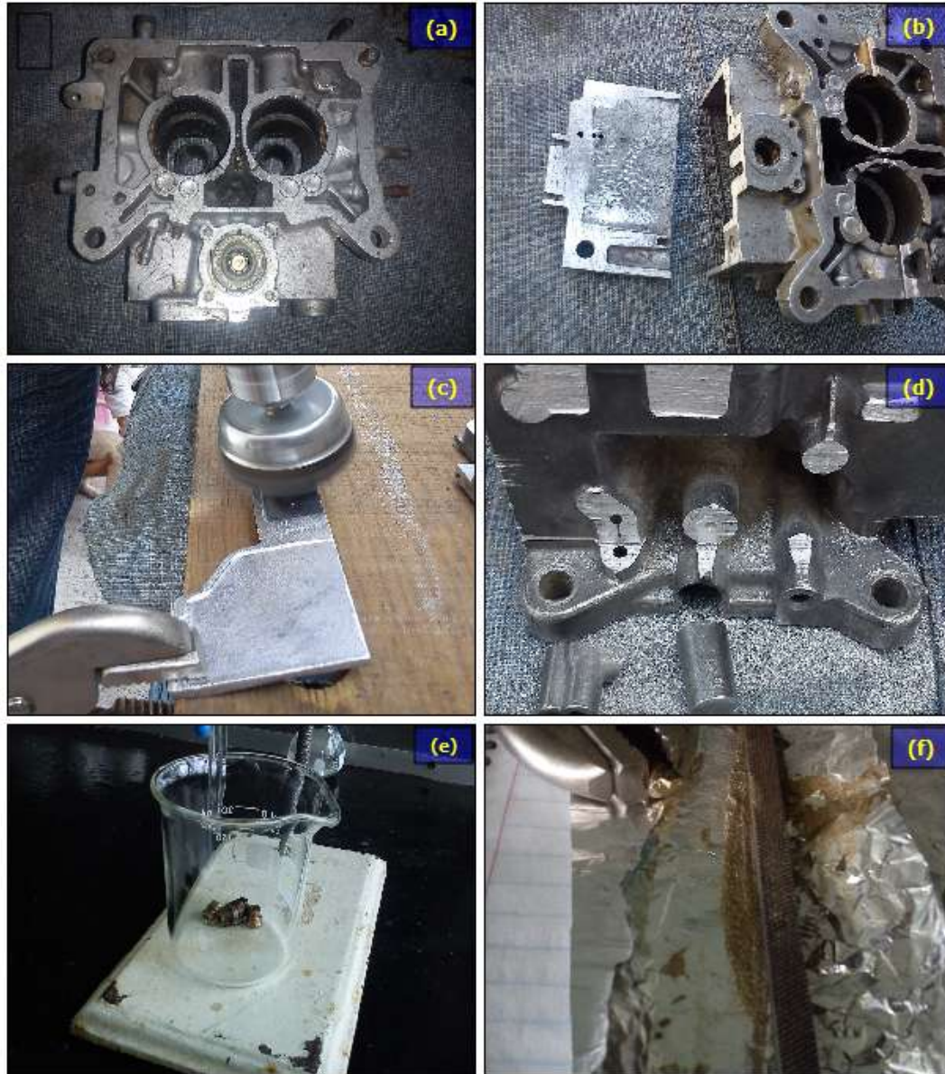
Figura 11.- a) Chatarra de carburador, b) Despiece del carburador, c) Limpieza con carda, d) Esquirlas de las láminas, e) Piezas limpiadas en sonicador, f) Limadura de chatarra.
