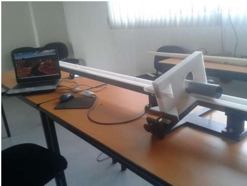
Figura 15. Equipo de Bartington, modelo MS2 y un sensor anillo modelo (MS2C) de 100 y 72 mm de diámetro.
