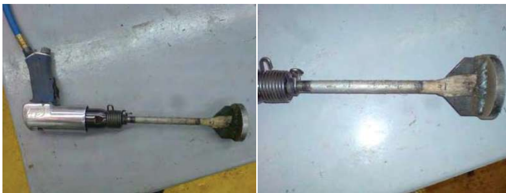
Figura 3. 16 Martillo neumático y pistón de compactación
