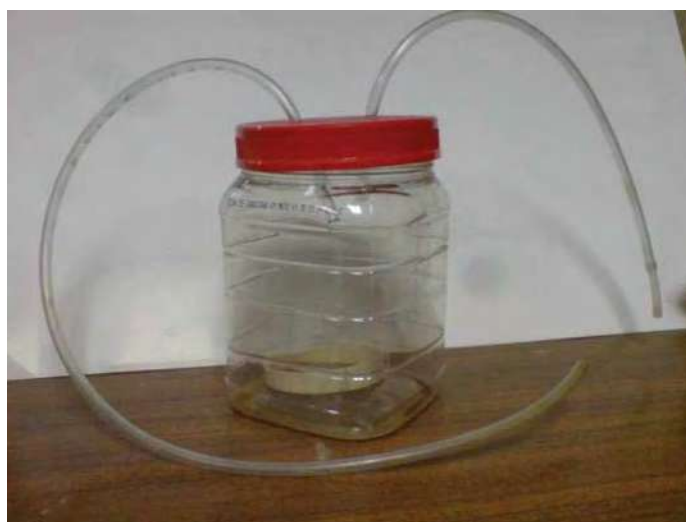
Figura 3. 23 Contenedor del higrómetro
