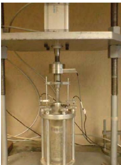
Figura 3. 25 Cámara montada en el marco de prueba
