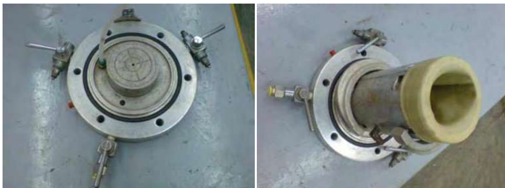
Figura 3. 15 Base de la cámara triaxial, conformación de los tres elementos.
