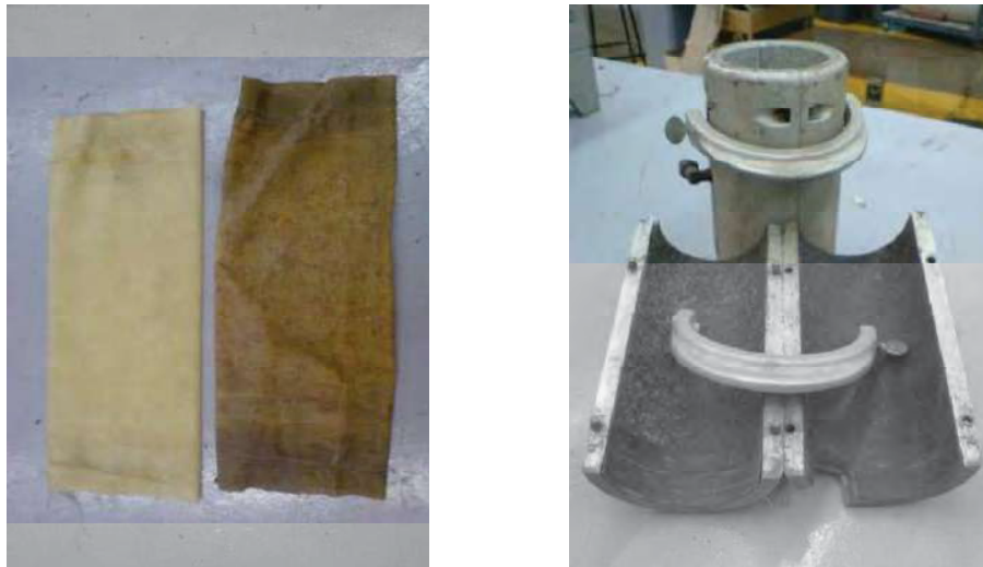
Figura 3. 14 Membrana de látex y molde
