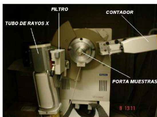
Figura 23: Principales componentes de un Difractómetro de Rayos X.
