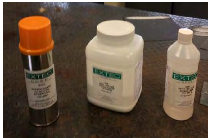
Figura 29. Resina epóxica en frío
