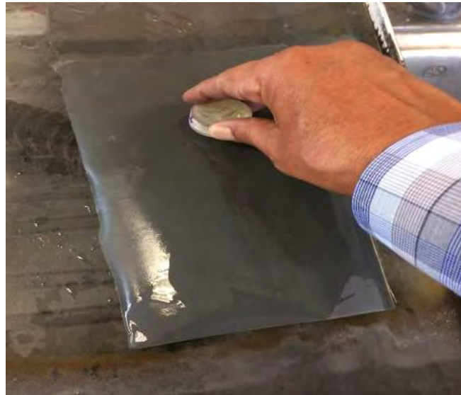
Figura 30. Lijado de las probetas con polvos metálicos de Ti-Ta-Sn.
