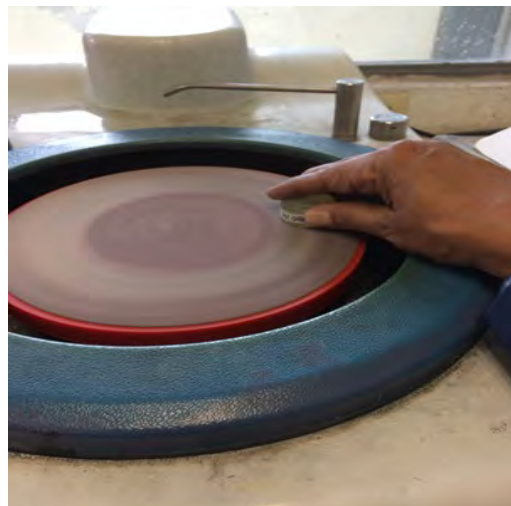
Figura 31: pulido de los polvos con pasta de diamante de 1\text{ }\mu\text{m} y 0.25\text{ }\mu\text{m}
