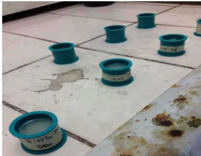
Figura 28. Recipientes conteniendo la resina epóxica con los polvos
