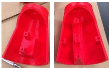
Figura 89 Modelo de soporte mejorado con impresión 3D a la izquierda versión 2 a su derecha versión 3 con soporte para imanes de neodimio, hecho en impresora 3D DREMEL
