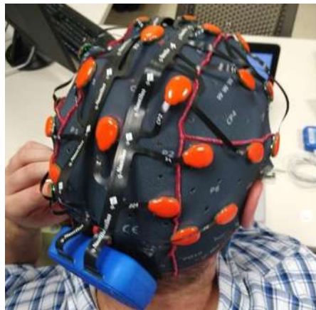
Figura 26 Electrodo activos de G-Tec en gorra portátil de EEG Nautilus. Archivo Autor.
