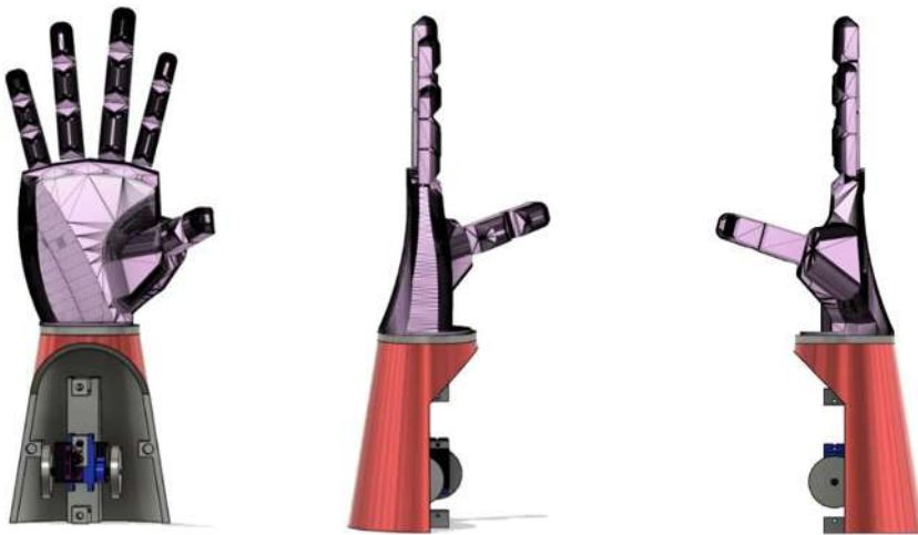
Figura 87 Diseño 3d del protético desarrollado en Fusion 360
