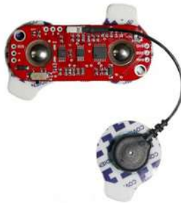
Figura 42 Sensor Mioeléctrico Sen_0708, mide, filtra, amplifica y produce una señal muscular electrónica [63]
