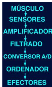
Figura 43 Diagrama del proceso de trabajo una interfaz mioeléctrica.
