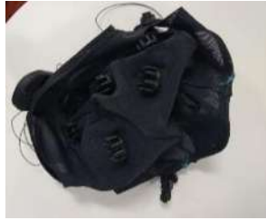
Figura 33 Electrodo seco G-Tec generados con aleaciones no metálicas [52].
