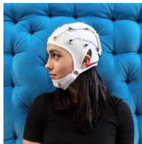
Figura 131 Ejemplo de mejora kit de gorra con 21 canales EEG de open BCI [56].
