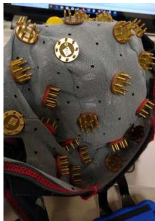
Figura 25 Electrodos secos de G-Tec. Archivo de Autor.
