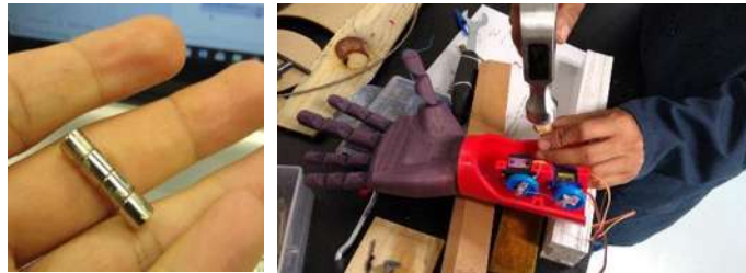
Figura 96 Implementación de imanes de neodimio como cierre en las tapas
