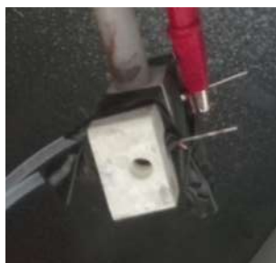
Figura 39. Agujas utilizadas para elaborar el material 26, unidas por un puente de cobre cubierto con aislante.
