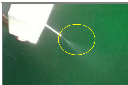
Figura 2.- Fotografía del jet durante el proceso de electrohilado. En el círculo amarillo se observa como el jet se dispersa hasta ser indetectable a la vista.
