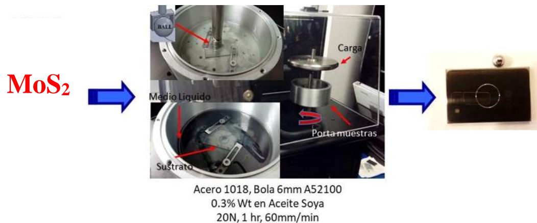
Figura 19. Esquema para pruebas tribológicas sumergidas en medio líquido.
