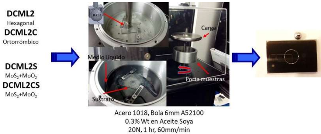
Figura 139. Esquema para pruebas tribológicas sumergidas en medio líquido.
