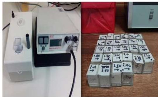
Figura 38. Equipo para medición de susceptibilidad magnética y muestras de sedimentos en cubos de acrílico.
