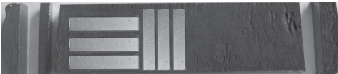
Figura 2.8 Localización de las Probetas para el ensayo de impacto.
