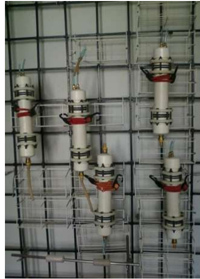
Imagen 2. Columnas empacadas y selladas herméticamente.
