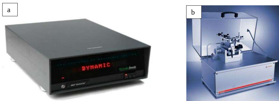
Figura 3. 6 a) Grindosonic y b) tribómetro marca Anton Paar.
