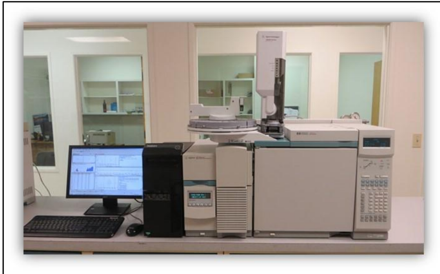
Figura 20. Equipo de cromatografía de gases acoplado a espectrometría de masas por impacto electrónico
