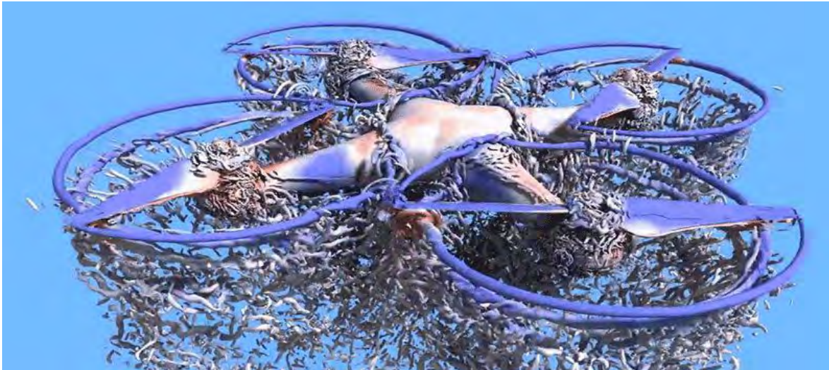
Figura 4.32 Simulación computarizada de corrientes dentro de cada rotor. Fuente: (Morán, 2018)
