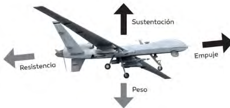
Figura 3.18 Las cuatro fuerzas principales que actúan durante el vuelo. Fuente: (García, Muñoz, & Albares, 2018)
