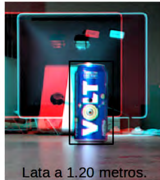
Figura 3.31: En esta Figura se observa el acercamiento al anaglifo de la Figura 3.29(1), donde claramente se puede apreciar que el objeto a una distancia de 120 centímetros, se puede visualizar a la perfección sin ningún tipo de descomposición de color, indicando así, que la disparidad a esa distancia, es igual a cero.
