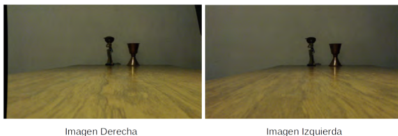
Figura 5.10: En la figura se muestra dos objetos, una copa de cobre, y una figurilla de arcilla. Ambos objetos fueron colocados a una distancia aproximada de entre 115.0 cm y 120.0 cm con respecto de las cámaras, con la finalidad de probar el funcionamiento del modelo.
