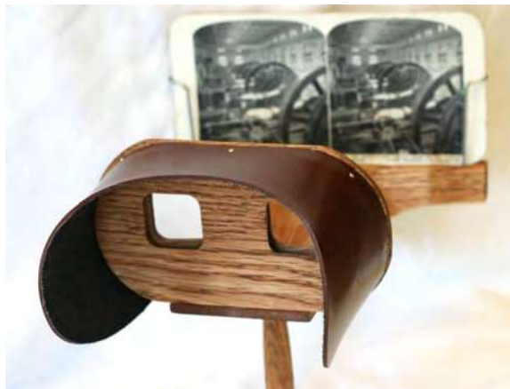
Figura 1.10: Estereoscópio de Wendell Holmes, funcional a partir de una imagen estereoscópica.
