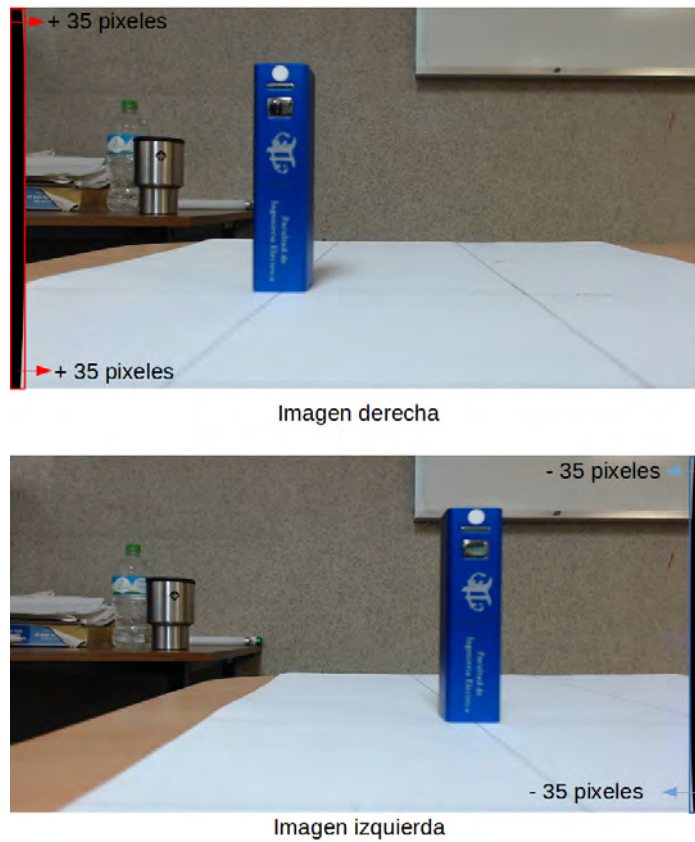
Figura 3.22: Desplazamiento en las imágenes tomadas con el sistema (imágenes izquierda y derecha respectivamente), después de modificar los centros de la cámaras.
