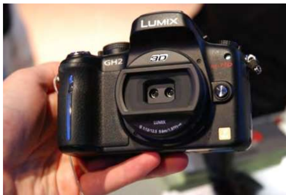
Figura 1.13: Cámara Panasonic Lumix DMC-GH2 con lente para imágenes 3D.
