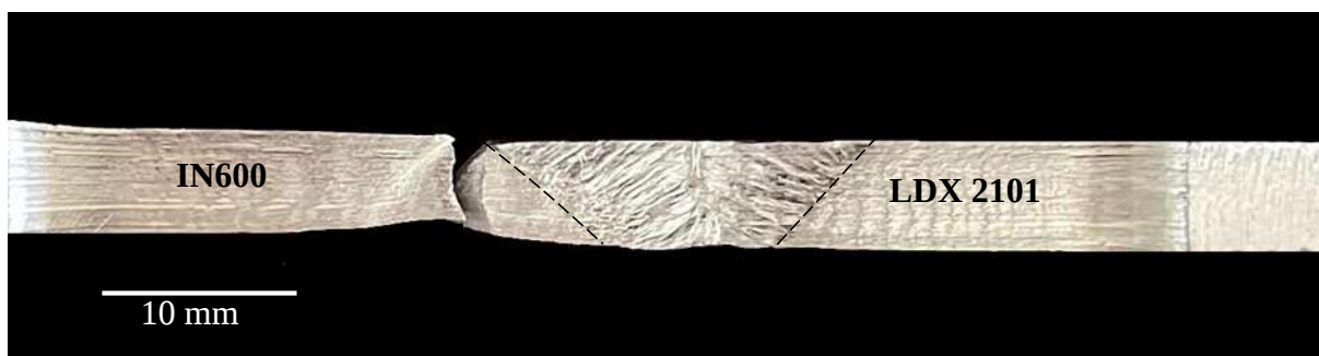
Figura 4. 27. Probeta de tensión fracturada de la unión empleando ERNiCrMo-3.
