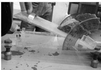
Figura 6.15. Equipo para la obtención del ángulo de rozamiento básico.
