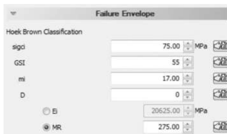
Figura 4.1. Parámetros de entrada en el criterio de Hoek- Brown.
