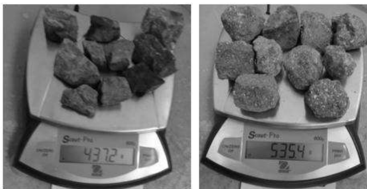
Figura 6.11. Se muestran dos especímenes preparados para la prueba de durabilidad.
