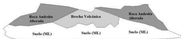
Figura 6.4. Corte longitudinal talud “El Alamo”.
