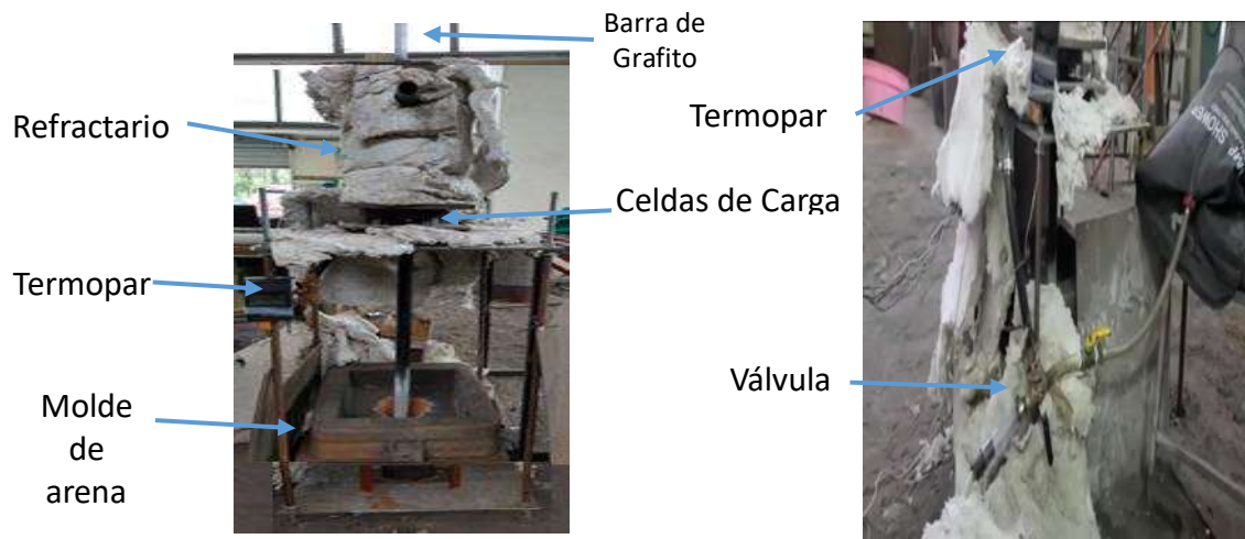
Fig. 23 Sistema de vaciado para experimentos con aluminio líquido.
