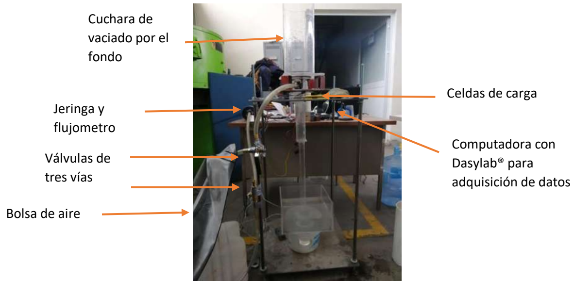
Fig. 31 Sistema utilizado para la medición del volumen de gas arrastrado utilizando agua como fluido.
