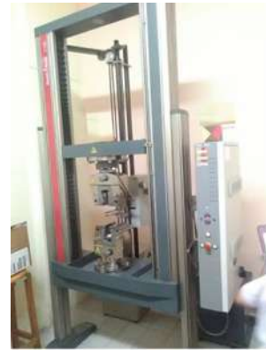
Fig. 28 a) Dimensiones de probeta para ensayo de tensión. b) Máquina de ensayos de tensión ZwickRoell®.
