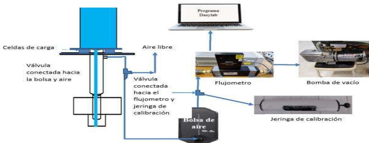
Fig. 12 Diagrama del sistema experimental para la medición de arrastre de aire.
