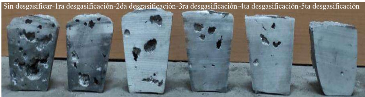
Fig. 44 Diferentes grados de desgasificación en muestras solidificadas a baja presión.
