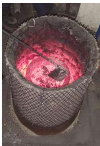
Fig. 24 Fusión del aluminio en horno de gas.
