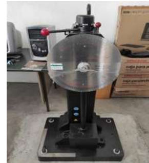
Fig. 29 a) Dimensiones de probeta para ensayo de impacto. b) Máquina de impacto Instron.
