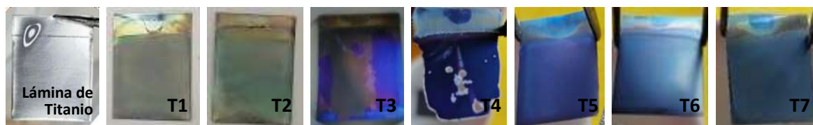
Figura 29. Lámina de titanio metálico (blanco) y sustratos anodizados y calcinados (Tratamientos T1-T7).
