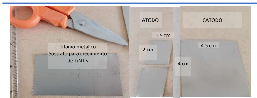
Figura 28. Corte de láminas de Titanio metálico
