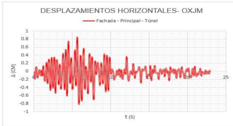
Figura 7.661. Análisis dinámico lineal en la historia del tiempo del macroelemento Fachada Principal con Túnel, con el acelerograma OXJM (7 de septiembre del 2017, Oaxaca), en el cual se representan los desplazamientos horizontales (CM) en la parte del extradós del túnel de la catedral de Morelia.
