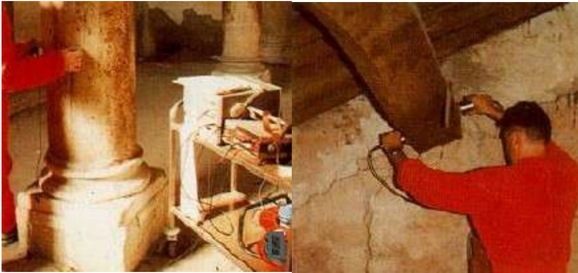
Figura 3.55. Pruebas de ultrasonido en un edificio histórico (Martínez, 2017).
