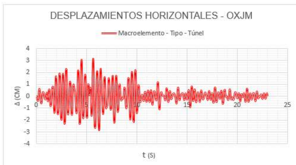
Figura 7.643. Análisis dinámico lineal en la historia del tiempo del macroelemento Tipo con Túnel, con el acelerograma OXJM (7 de septiembre del 2017, Oaxaca), en el cual se representan los desplazamientos horizontales (CM) en la parte del extradós del arco de la bóveda principal de la catedral de Morelia.
