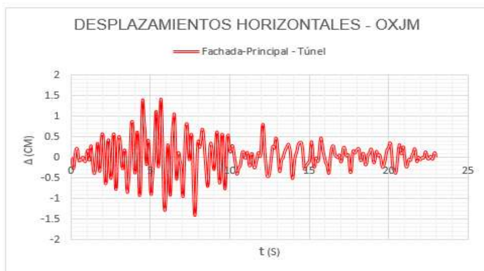
Figura 7.660. Análisis dinámico lineal en la historia del tiempo del macroelemento Fachada Principal con Túnel, con el acelerograma OXJM (7 de septiembre del 2017, Oaxaca), en el cual se representan los desplazamientos horizontales (CM) en la parte del extradós del arco de la bóveda principal de la catedral de Morelia.
