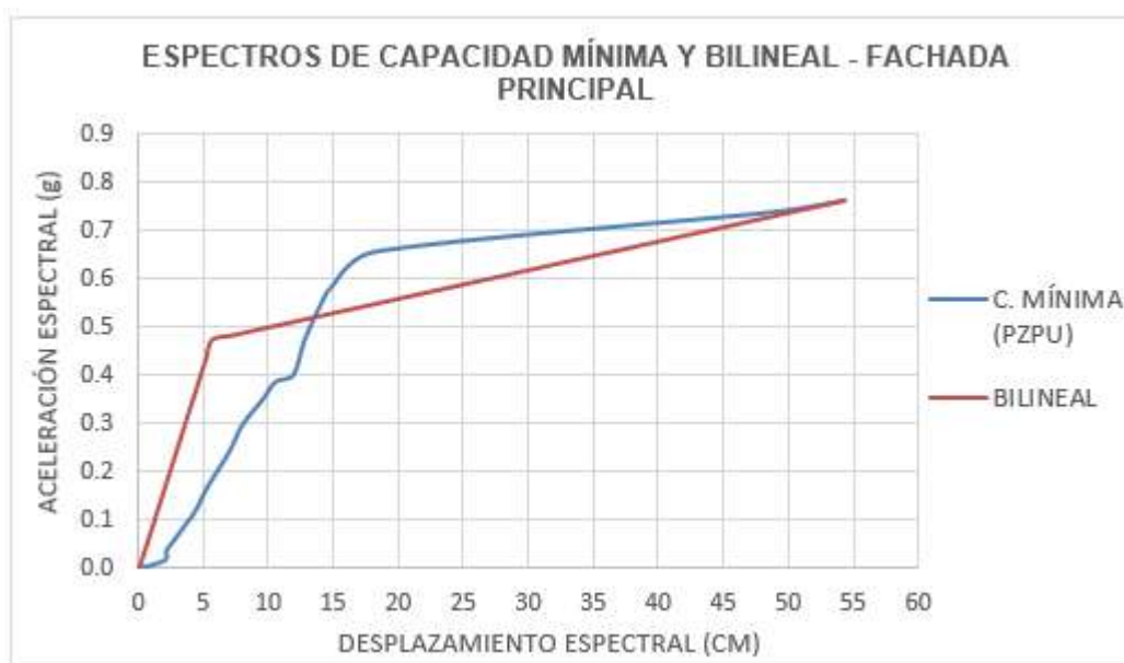
Figura 8.527. Espectro de mínima capacidad (PZPU) y su bilinealización correspondiente al macroelemento Fachada principal de la catedral de Morelia.
