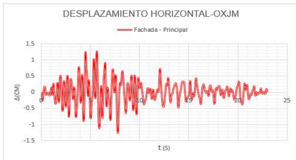
Figura 7.625. Análisis dinámico lineal en la historia del tiempo del macroelemento Fachada Principal, con el acelerograma OXJM (7 de septiembre del 2017, Oaxaca), en el cual se representan los desplazamientos horizontales (CM) del extradós del arco de la bóveda principal de la portada tripartita de la catedral de Morelia.
