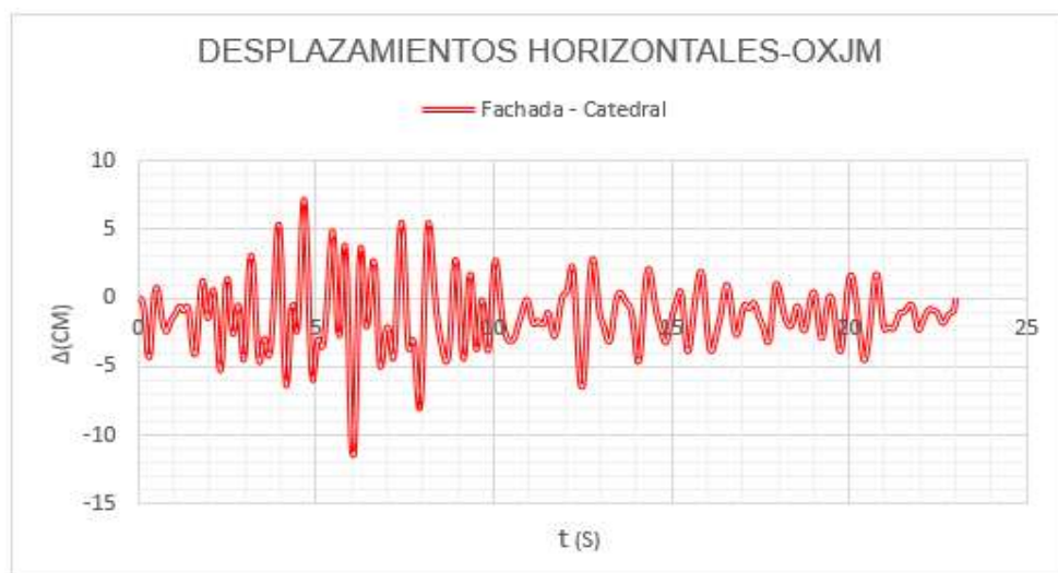
Figura 7.625. Análisis dinámico lineal en la historia del tiempo del macroelemento Fachada Principal, con el acelerograma OXJM (7 de septiembre del 2017, Oaxaca), en el cual se representan los desplazamientos horizontales (CM) del extradós del arco de la bóveda principal de la portada tripartita de la catedral de Morelia.
