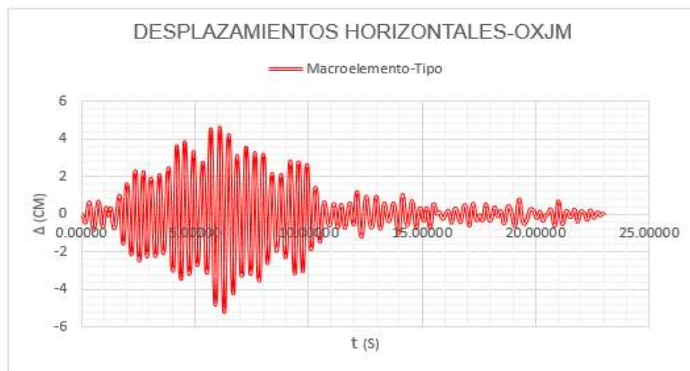
Figura 7.613. Análisis dinámico lineal en la historia del tiempo del macroelemento Tipo, con el acelerograma OXJM (7 de septiembre del 2017, Oaxaca), en el cual se representan los esfuerzos principales (T/M 2 ).
