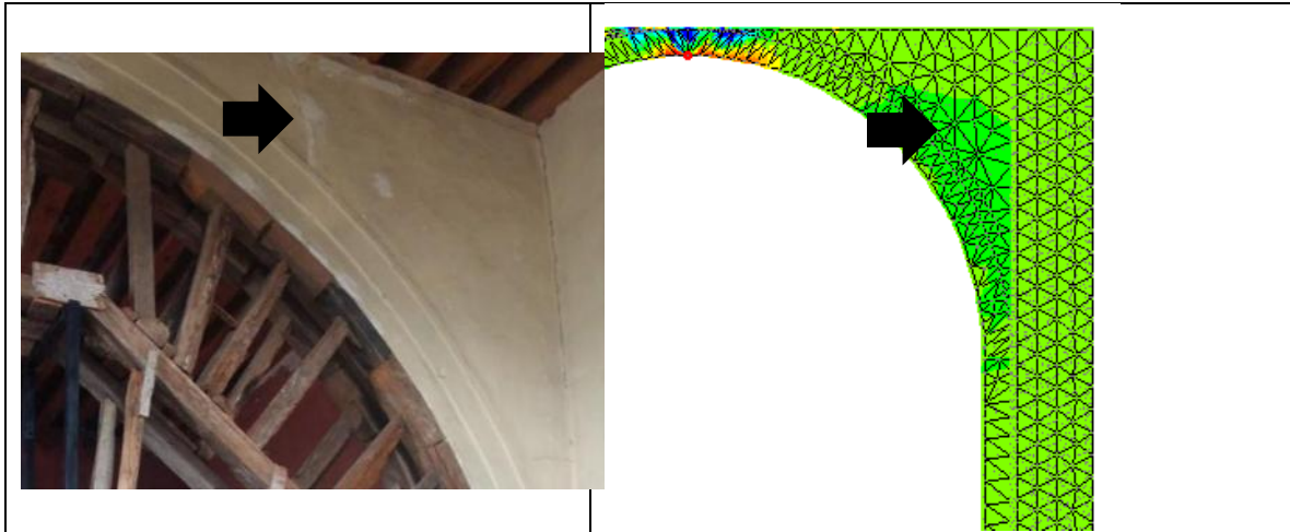
Fig. 154 Comparación de imágenes reales cara oeste del arco con la forma modal analizada 167
