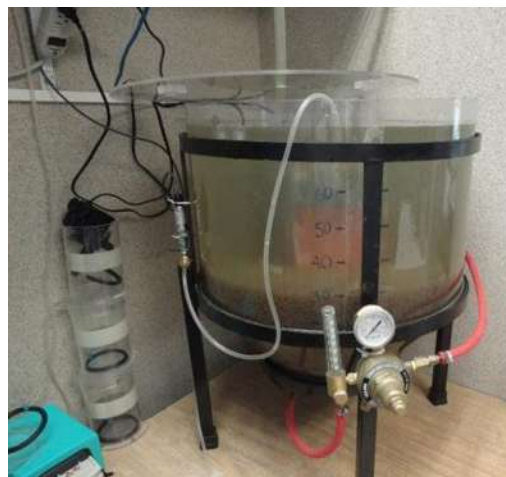
Fig. 3.5 Vista del BRM experimental recién inoculado
