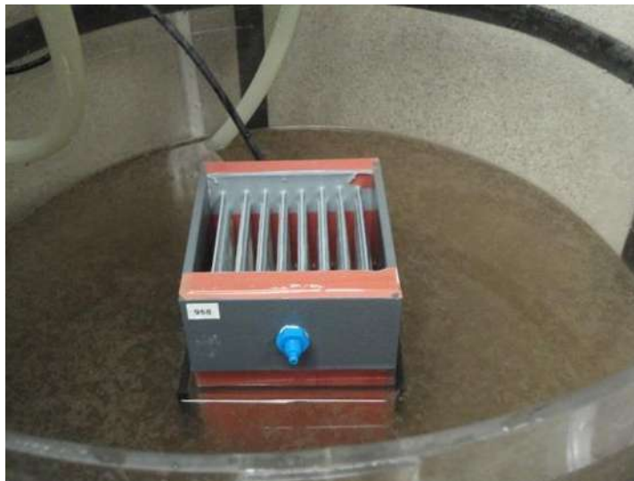
Fig. 3.6 Imagen del módulo de membranas instalado en el BRM
