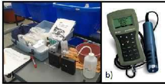
Figura 19. Equipo utilizado para medición de parámetros fisicoquímicos del agua. a) HACH® modelo FF1A, b) multiparamétrico HANNA® modelo HI9828.
