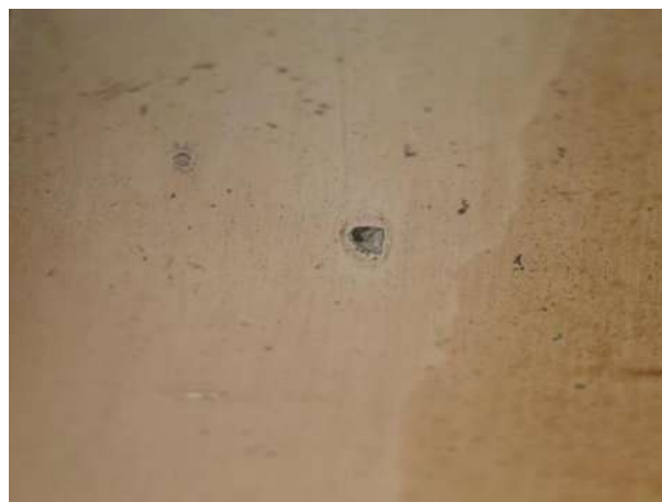
Figura 4.14 Lámina Ti_{60}Cu_{40} sometida a ataque químico (Kroll's reagent 192) a 200x.
