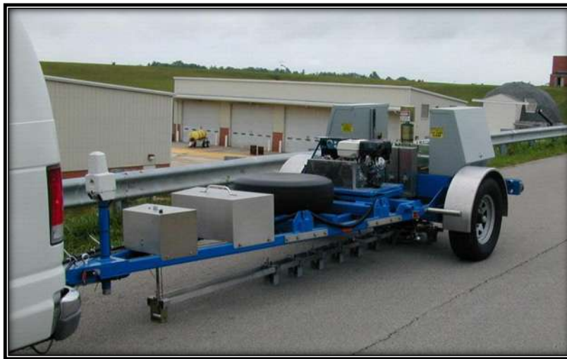
Figura 1.5: Deflectómetro de impacto actual (Smith et al., 2017).
