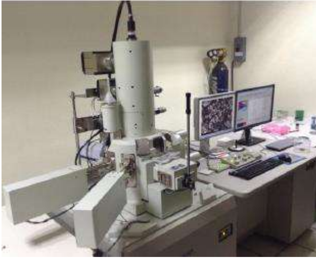
Figura 3.6 (a) Microscopio electrónico de emisión de campo marca JEOL modelo JSM-7600F FEG-SEM, (b) volumen de interacción del haz de electrones y los átomos de la muestra.
