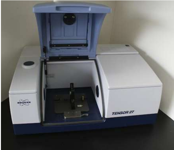
Figura 3.9 (a) Espectrofotómetro FTIR modelo Tensor 25 de la marca Bruker, (b) Diagrama de estados de energía vibracionales [105].
