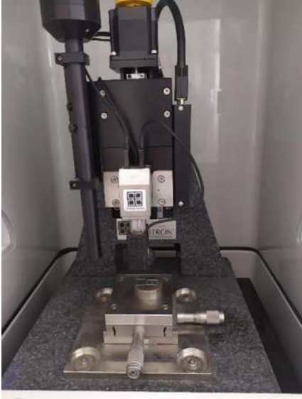
Figura 3.10 (a) Nanoindentador Hysitron Nanomechanical Test Instruments, (b) medición de propiedades mecánicas de películas delgadas mediante nanoindentación [106].
