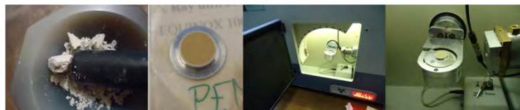
Figura 38. Preparación y colocación de muestras en difractor. Fotos: A. Cuéllar
