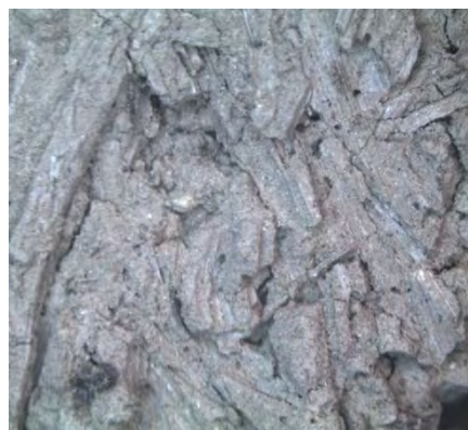
Figura 67. Imagen al microscopio de un cementante. Se observa la gran cantidad de improntas o huellas de fibras vegetales. Procedencia: Plazuelas Fotos: A. Cuéllar
