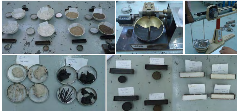
Figura 35. Imágenes del proceso para establecer límites de Atterberg. Fotos: A. Cuéllar
