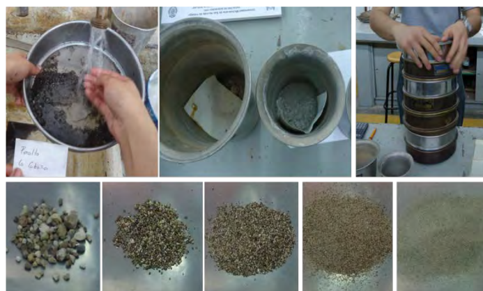
Figura 36. Proceso para establecer la granulometría de los suelos. Fotos: A. Cuéllar
