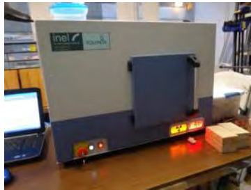
Figura 37. Equipo de difracción utilizado (UNAM). Foto: A. Cuéllar
