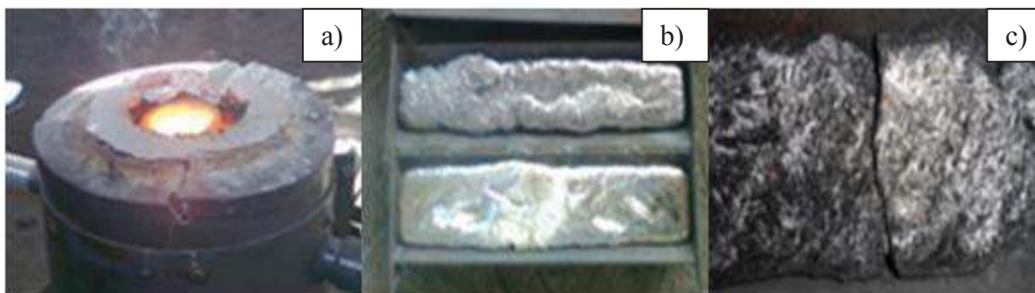
Figura 2.3.- a) Horno de inducción inductotherm. b) aleaciones completamente solidificadas empleando moldes metálicos. c) Fragmentación de la aleación por fragilización ambiental.
