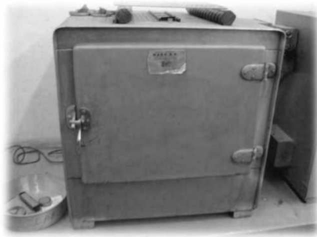
Figura 0-3. Horno utilizado para determinar el contenido de humedad.
