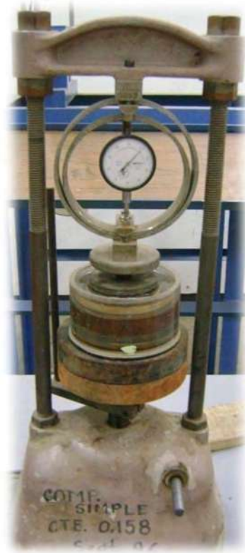
Figura 0-33. Aparato utilizado para la presión de expansión.
