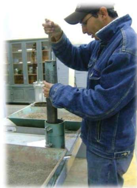
Figura 0-17. Compactación con el pisón aplicando 25 golpes para cada capa.
