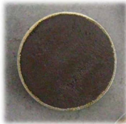
Figura 0-25. Arcilla en el molde después de golpearlo varias veces para que el aire atrapado suba a la superficie.
