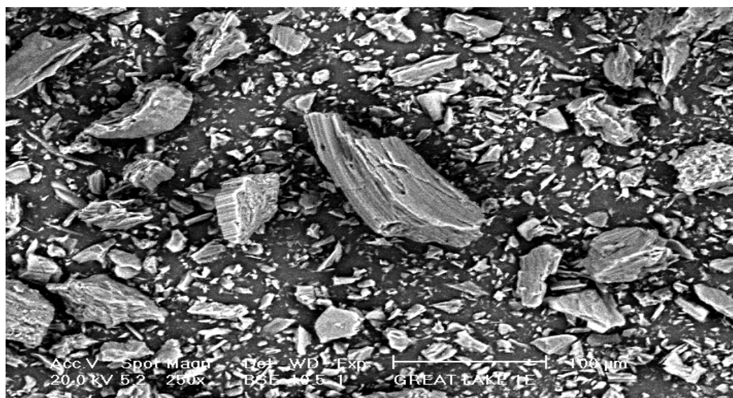
Figura 1.12. Micrografía de un coque de petróleo en modo de electrones retro dispersados (BSE). Variación granulométrica observada a 250X. Micromarca de 100 \mu m (Subero y col., 2006).
