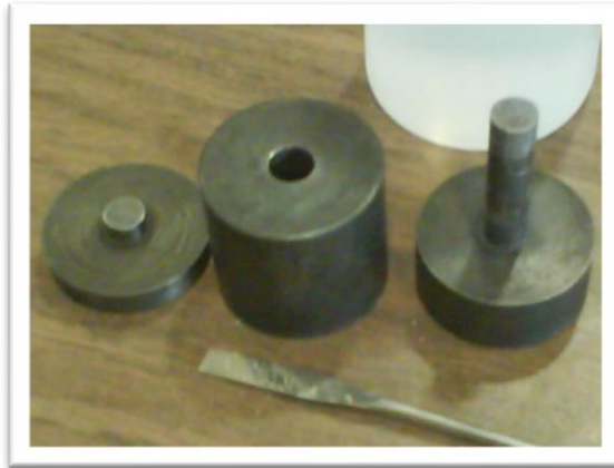
Figura 2.2 Dado utilizado para compactación de las preformas porosas
